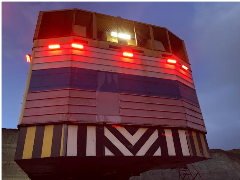
Бортовое освещение добывающей техники в угольном разрезе экскаватор (ЭКГ 10)
