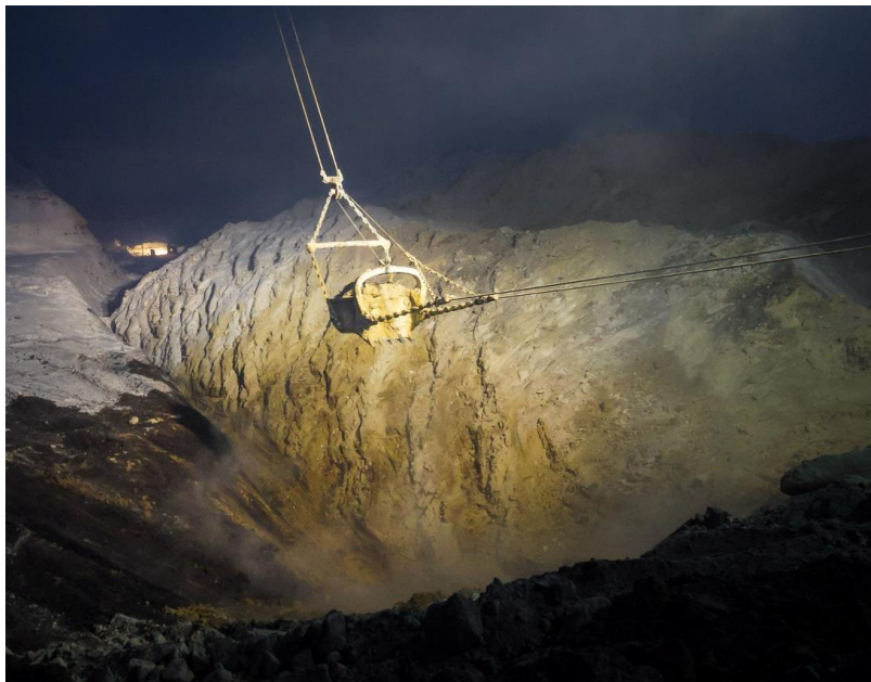
Освещение поверхности забоя с шагающего экскаватора
